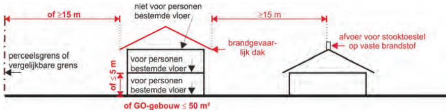
figuur 31 Brandgevaarlijk dak nieuwbouw
