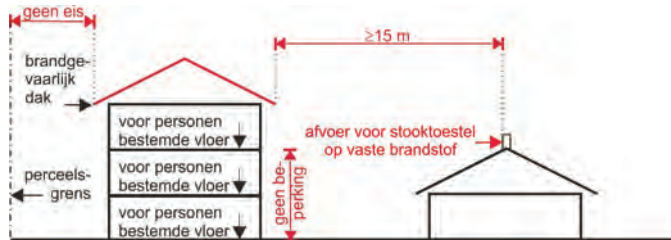
figuur 32 Bestaand brandgevaarlijk dak
